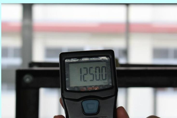
新しい水車実験装置はケーシングのふたをアクリルボードで製作したため、流れ場が可視化できています。水車の羽根の形状を変えながら、最適な形状を探しています。今日の発電機の1分間あたりの回転数は1250回転でした。この回転数が発電時にも維持されると発電が可能となります。
