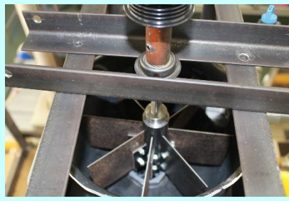
炊飯器釜を利用したケーシング
