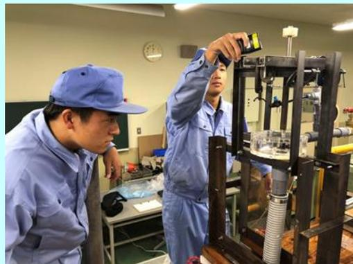
しかしながら、プーリーを用いてオルタネータに繋いだところ、トルク不足が原因で水車を回転させることは出来ませんでした。そこで、水力実験装置についているペルトン水車の出力軸にオルタネータをプーリーでつないで、ペルトン水車を約1200rpmで回転させたところ、13.3V、3.5A（最大7A）の電流をオルタネータが発電し、バッテリー（12V）に充電できることが確認できました。この実験から、水車を用いて自動車のオルタネータを回転させて発電し、バッテリーに蓄電することは可能であることが確認できました。実際に照明として使用する際には、バッテリーからインバーターを通して、100Vの交流に変換して使用します。
