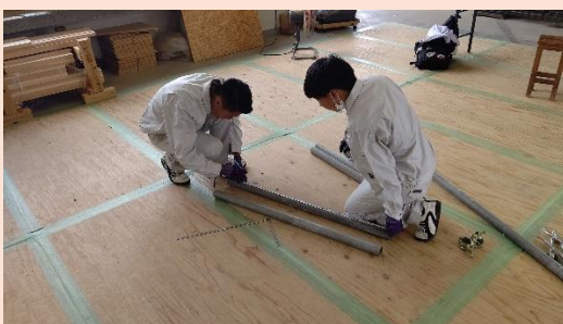
足場用単管を使用した、測定用器具を製作の様子
