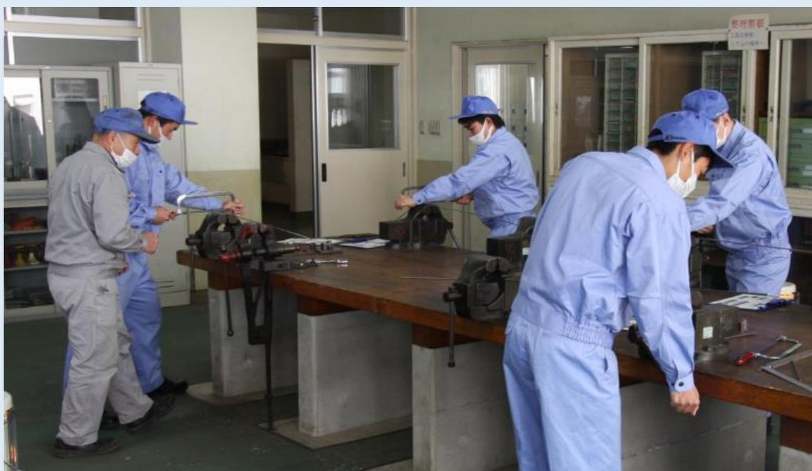
令和4年2月、機械・ロボット科1年生の工業技術基礎において、鍋敷きの製作を行っています。ミガキ棒 (SS400)  $\phi 5$ 、 $\phi 4$  を、切断、曲げ加工、ガス溶接し、一年間学んだ技術で完成させます。
