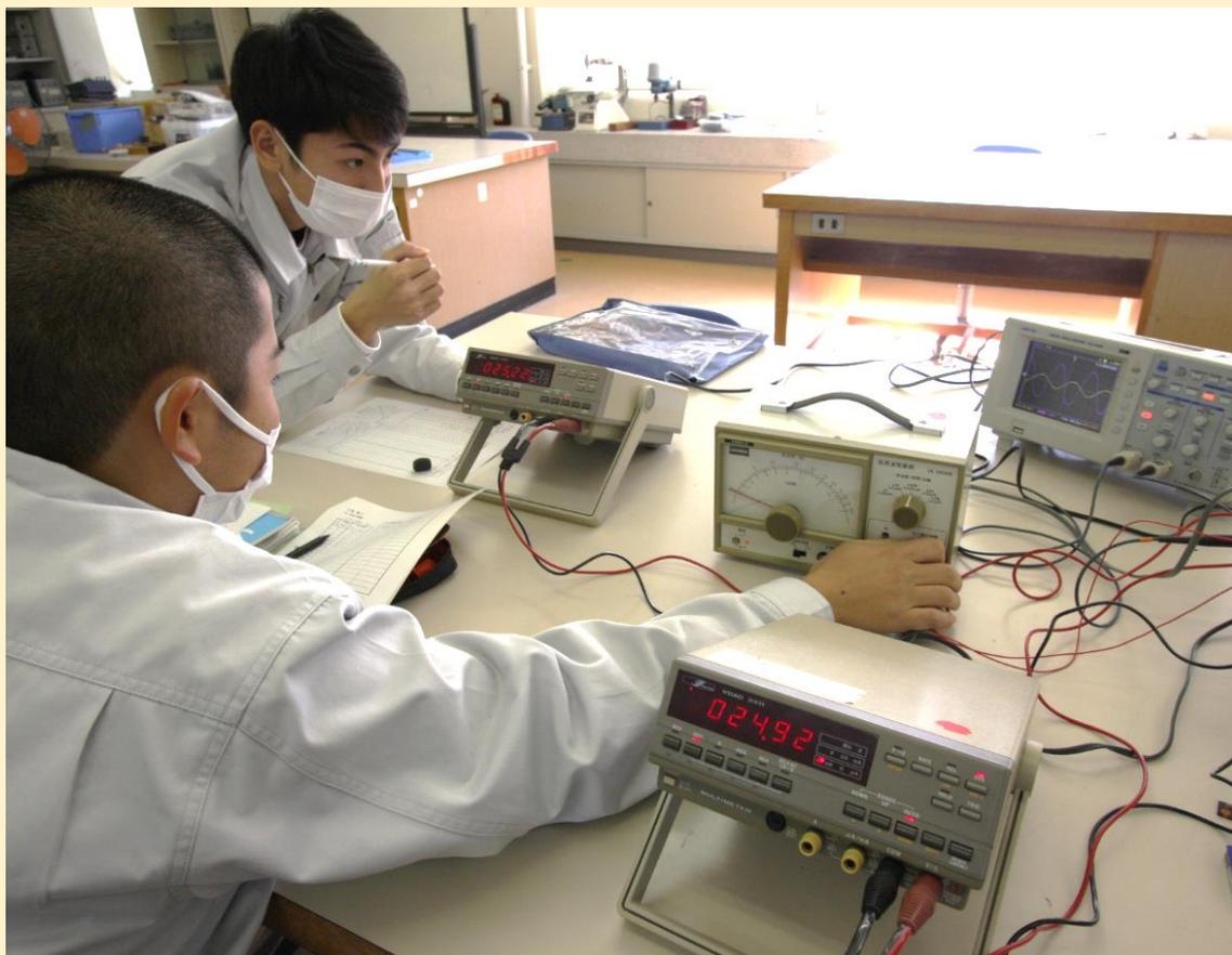
令和4年2月、建築・電気科2年 電気コースの実習において、トランジスタ増幅器の特性試験を行っています。
