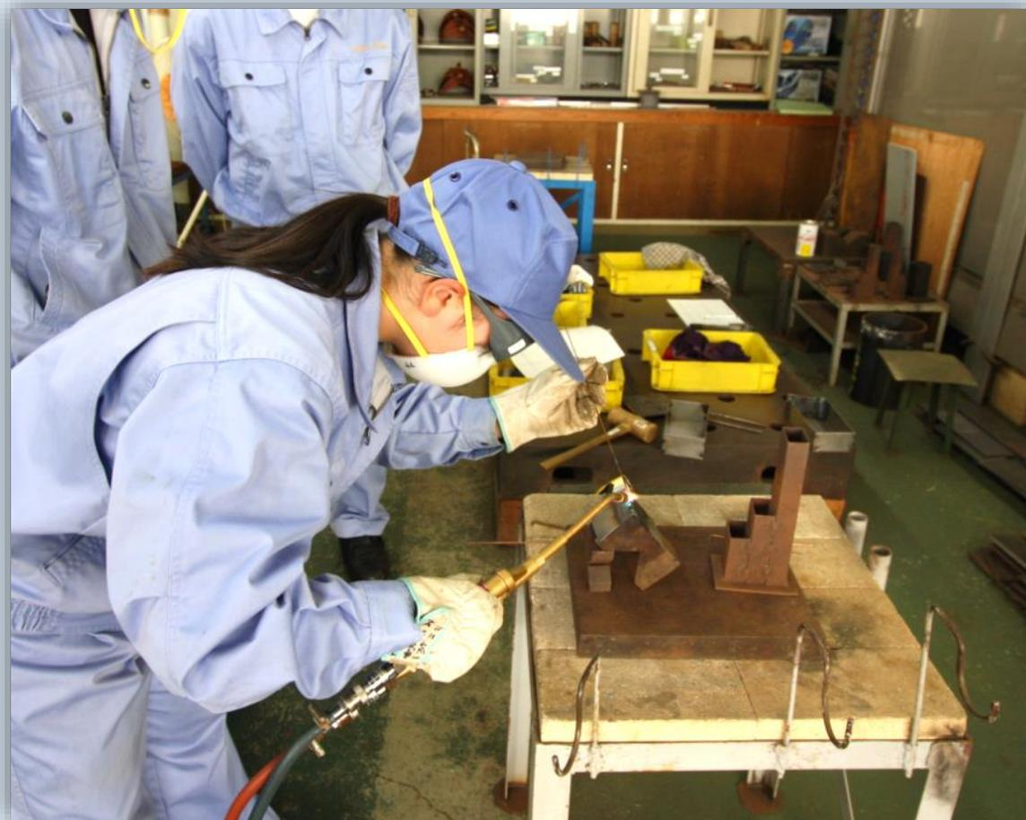
令和3年10月、機械・ロボット科3年生の実習において、3年間で学んだ曲げ加工、抵抗溶接、ガス溶接（アセチレン、酸素）の集大成として工具箱を製作しています。
