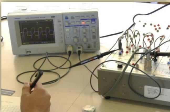
令和3年9月、建築・電気科3年 電気コースの実習において、マルチバイブレータの実験を行っています。
