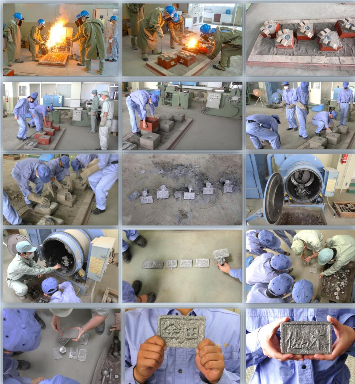
令和3年9月21日(火)、機械・ロボット科2年生の実習 砂型鑄造法の5週目となります。前回鑄型に流し込んだ鑄鉄を取り出し、今回は仕上げを行い、作品を完成させます。まずは、ショットブラストをかけて鑄物に付いた砂を取り去り、その後、バリ取りを行い完成しました。
