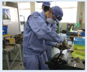
令和3年6月、機械・ロボット科3年 生の実習において、3年間で学んだ曲げ 加工、抵抗溶接、ガス溶接(アセチレン、 酸素)の集大成として工具箱を製作して います。
