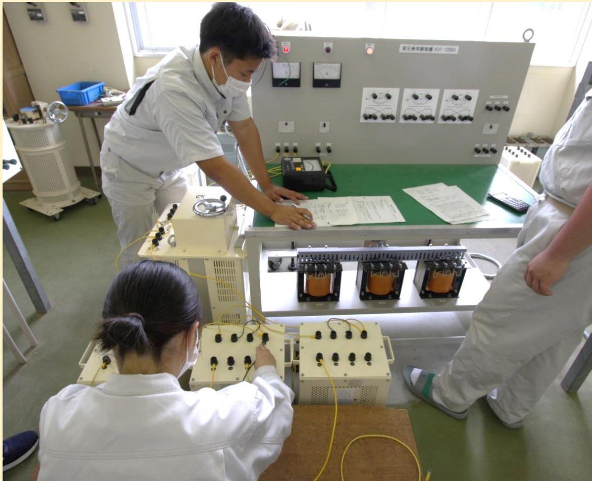
令和3年6月、建築・電気科3年 電気コースでは、単相変圧器の各種三相結線についての実験を行っています。
