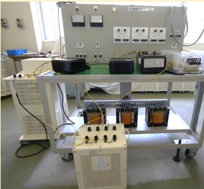
令和3年6月、建築・電気科3年 電気コースでは、単相変圧器の特性試験を行っています。
