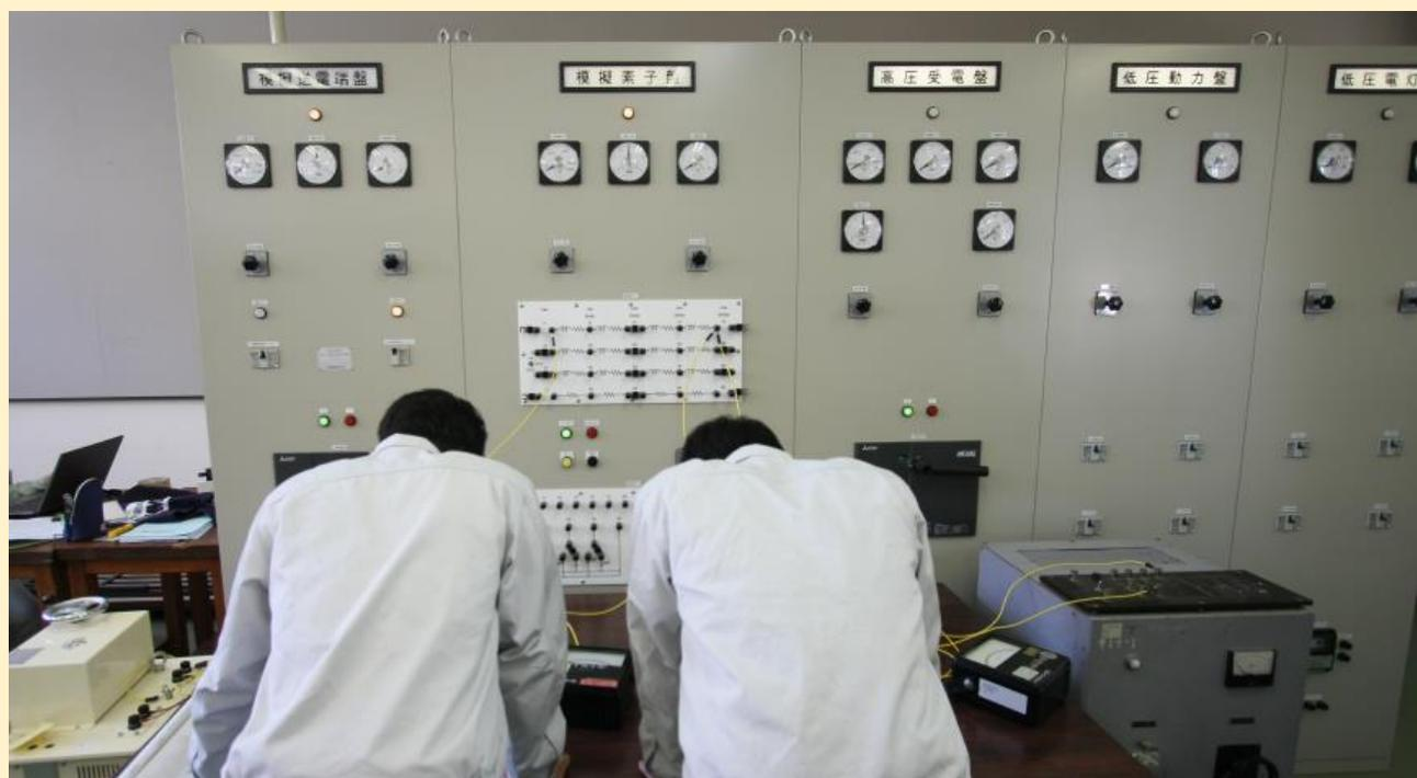
令和3年5月、建築・電気科3年生は、模擬送電線路による送電線特性の実習を行っています。
