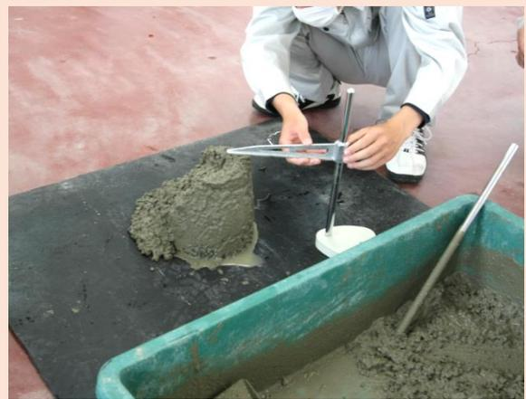
令和3年5月、建築・電気科2年建築コースでは、コンクリートの調合設計と供試体の製作を行っています。
