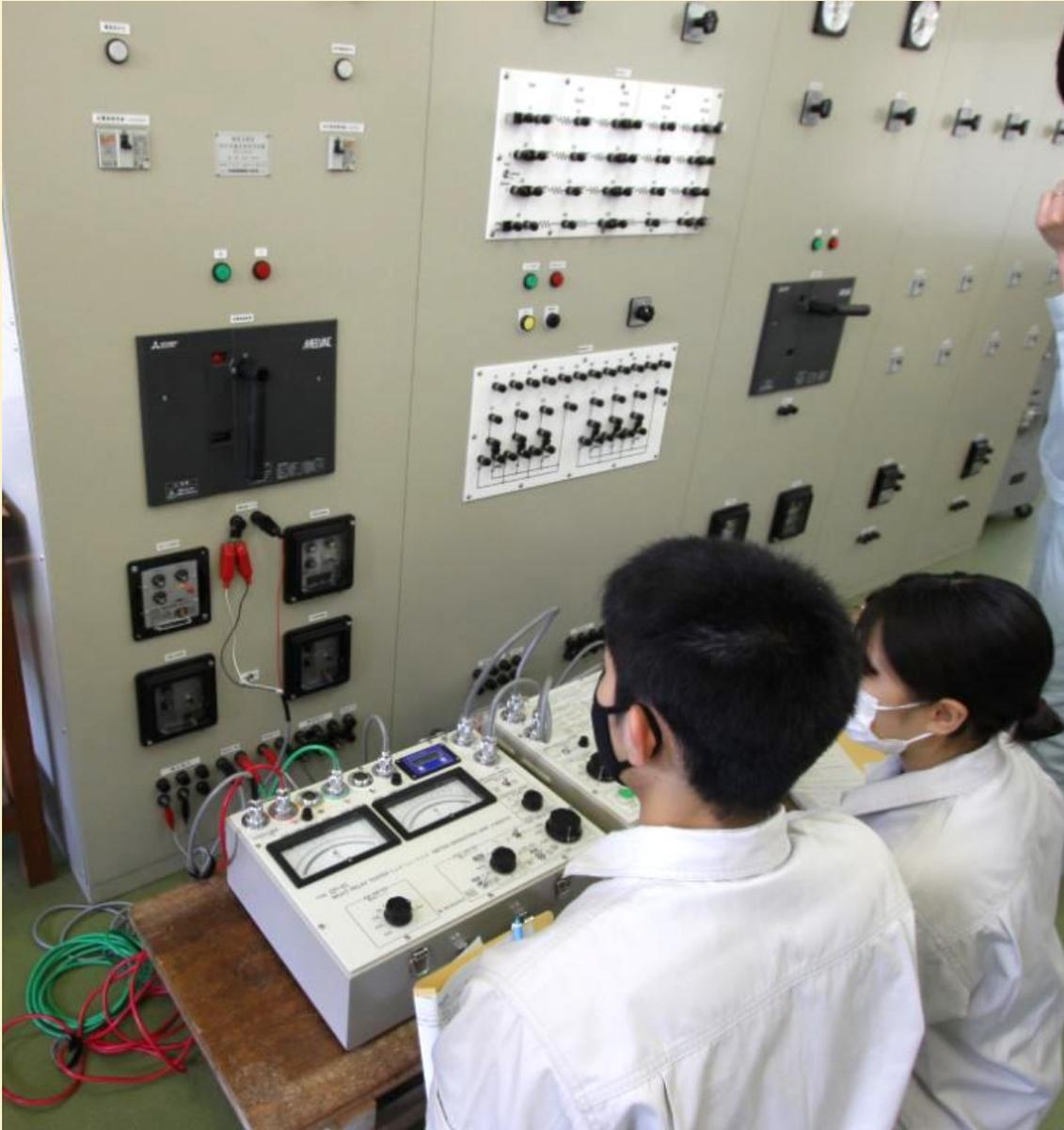
令和3年4月21日（水）、建築・電気科3年 電気コースでは、保護継電器の動作特性試験を行いました。
