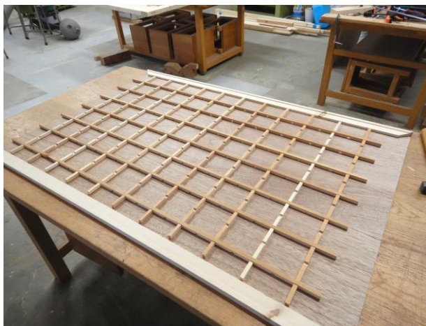
図16 黒板の内部構造
