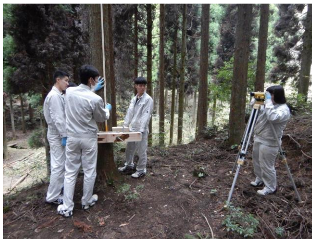
図30 レベルを用いた高さ調整の様子
