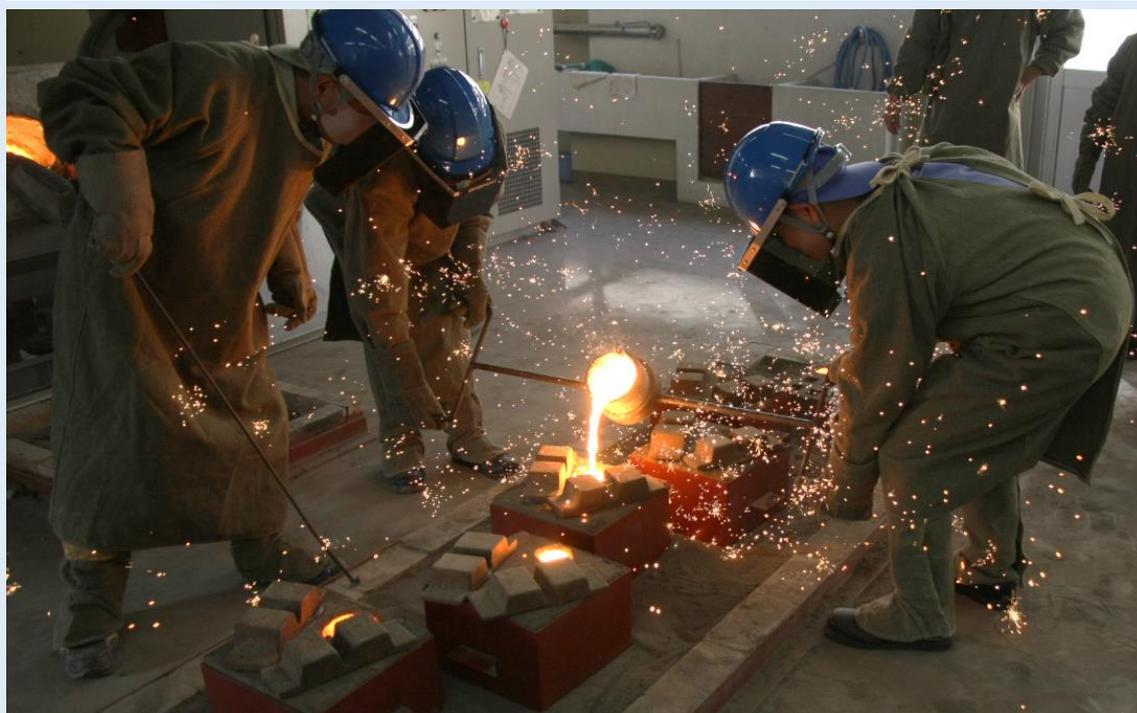
令和2年12月8日(火)、機械・ロボット科2年生の実習で2回目の鑄造(ちゅうぞう)を行いました。この実習は、鑄鉄を高周波溶解炉で溶解(1450℃)し、先週までに製作した砂で作った鑄型(いがた)に流し込んで製品を作るものです。高周波溶解炉から溶けた鑄鉄が黄色く光りながら流れ出します。これを専用の容器で運び、鑄型に流し込みます。十分に固まり冷やしてから、製品を取り出し、次回の実習では、研磨などの仕上げを行い作品が完成します。
