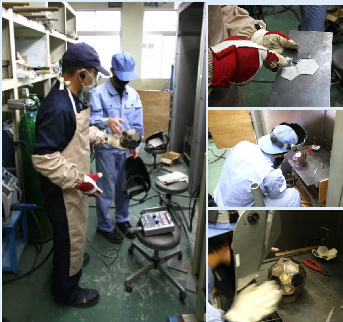
令和2年11月20日の途中経過報告。7月から、TIG溶接技術を習得するため、島根県職業能力開発協会の溶接マイスター杉原光弘氏に指導を仰ぎ練習を開始しています。前回仮溶接した球体に本溶接を行いました。1日で全面の溶接ができるようになり、先輩の技術を超える出来映えで製作することができました。次回は、水圧をかけて球体を作ります。
