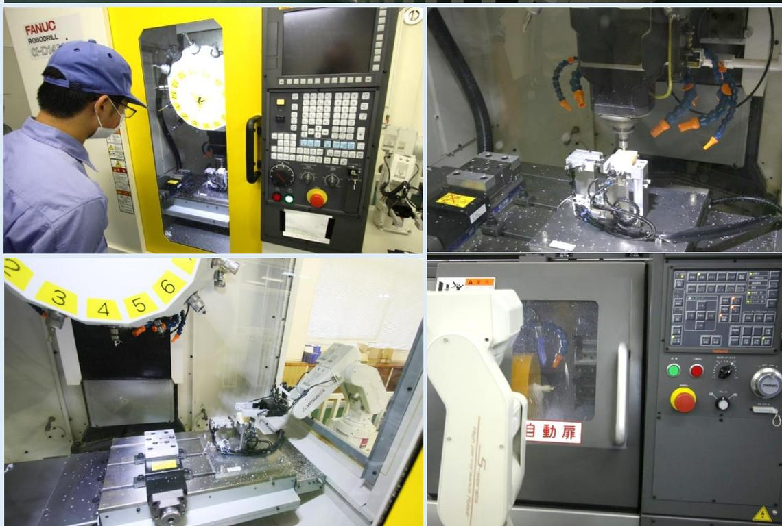
令和2年10月末、機械・ロボット科3年生の実習は、2ローテーション目に入りました。2年次にNC加工実習を行い、3年次は総合実習としてFMS実習を行います。エフ・エム・エス【FMS】[flexible manufacturing system]とは、複数のNC工作機械に、それらを結ぶ自動搬送装置（ベルトコンベア、無人自動搬送車、アームロボットなど）、材料・部品・工具などを自動的に入出庫する保管装置（自動倉庫）や統括的に管理・制御するコンピュータなどの機能を加えた多品種少量生産システムのことです。
