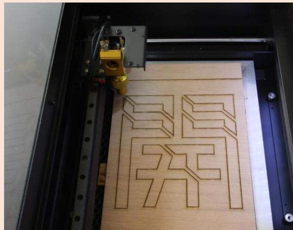
加工データを作成し、レーザー加工機でベニヤ板を焼き切ります。加工が困難な材料でもレーザー加工機を使用すれば加工できます。
