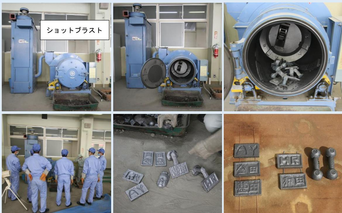
令和2年10月、機械・ロボット科2年生の実習 砂型鑄造法の5週目となります。前回鑄型に流し込んだ鑄鉄を取り出し、今回は仕上げを行い作品を完成させます。まずは、ショットブラストをかけて鑄物に付いた砂を取り去りその後バリ取りを行い完成しました。
