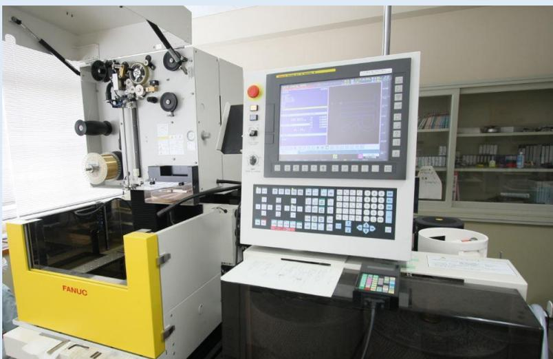
令和2年9月、機械・ロボット科3年生の実習において、ワイヤー放電加工機を使用した金属加工を行っています。
