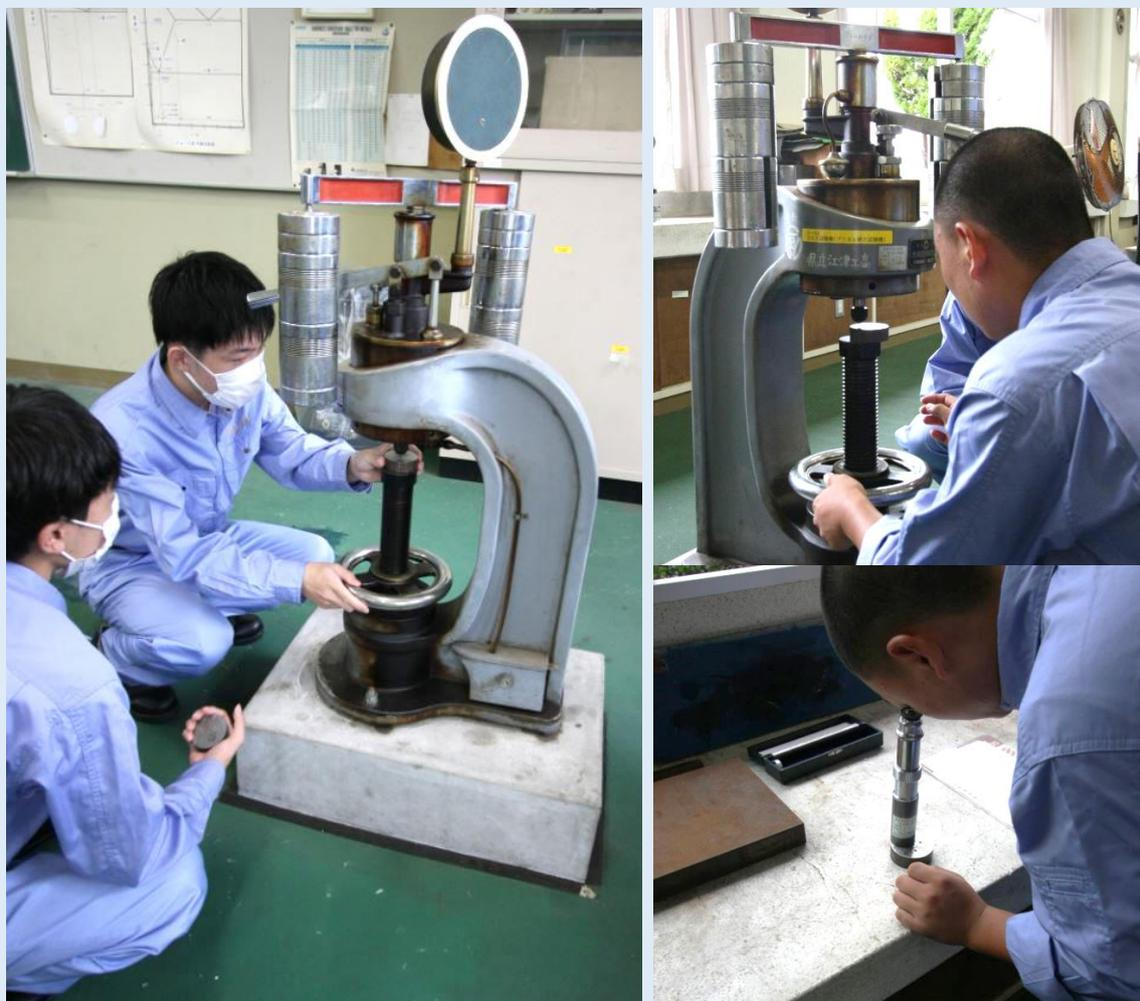
令和2年7月、機械・ロボット科1年生の工業技術基礎において、金属の硬さ試験を行っています。
