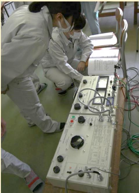
令和2年6月、建築・電気科3年 電気コースでは、保護継電器の動作特性試験を行っています。
