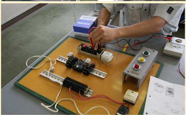
令和2年6月、建築・電気科2年 電気コースでは、電磁リレーを使用したシーケンス制御(あらかじめ定められた順序に従って、制御の各段階を次々と進めていく制御)に関する基礎実験を行っています。
