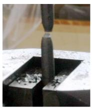
令和元年10月、建築・電気 科2年建築コースでは、鉄筋の 引張試験を行っています。
