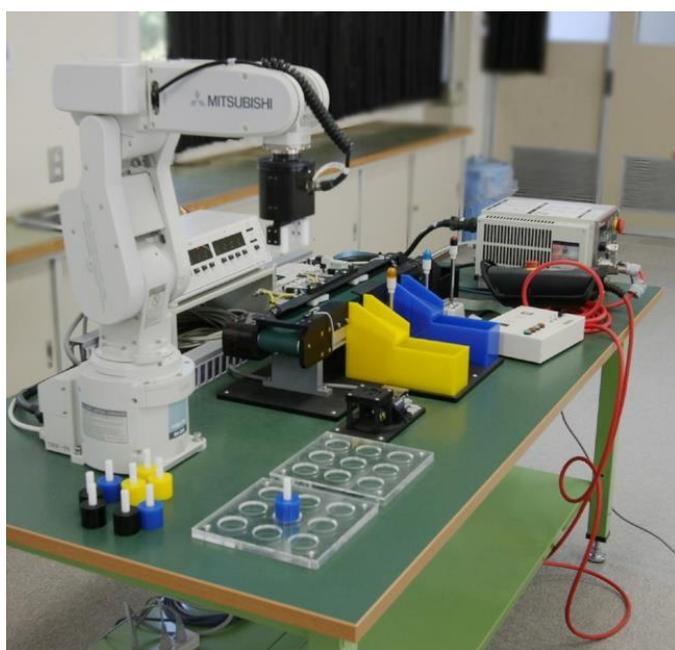
令和元年9月、機械・ロボット科3年生の実習において、ロボットアームの制御（カラーセンサの利用）を行っています。
