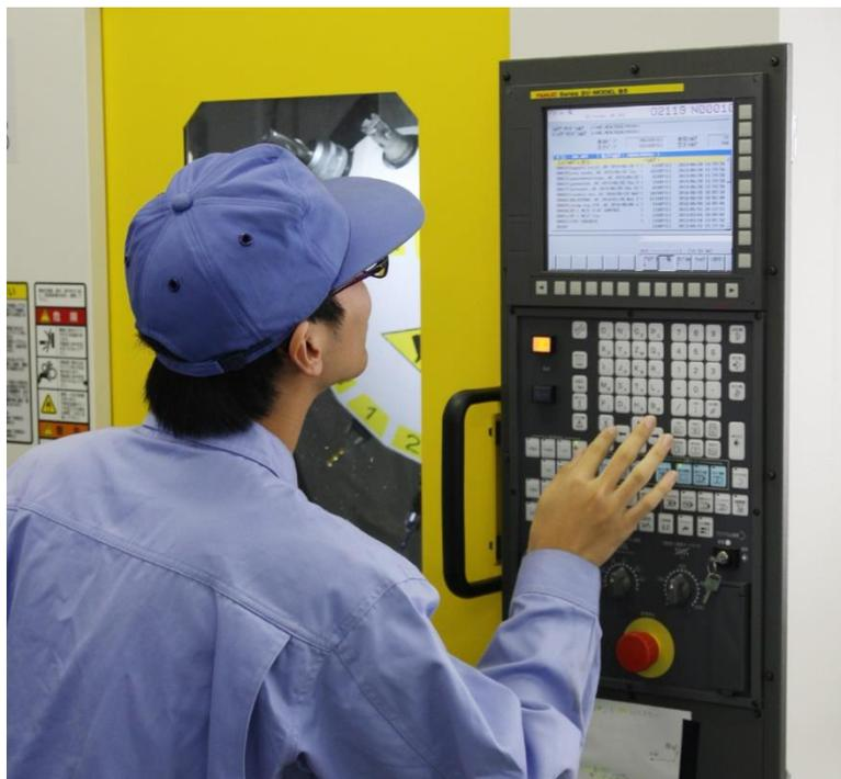
マシニングセンタ (machining center)は、自動工具交換機能を持ち、目的に合わせてフライス削り、中ぐり、穴あけ、ねじ立てなどの異種の加工を1台で行うことができる数値制御工作機械。工具マガジンには多数の切削工具を格納し、コンピュータ数値制御 (CNC)の指令によって自動的に加工を行う。
