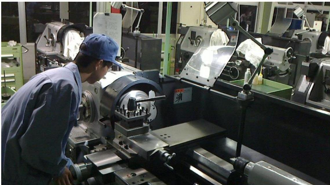
1月12日に行われる技能検定3級（旋盤作業）を受験する機械・ロボット科2年の生徒が、江津市二宮町にあるポリテクカレッジ島根（島根職業能力開発短期大学校）で検定課題の練習をしています。生徒は、
