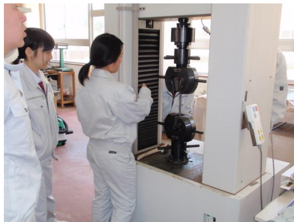
鉄筋の引張試験
